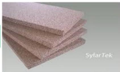
**SyfarTek** è un pannello di sughero biondo naturale a grana fine compresso (granulometria 2/5mm). Le sue dimensioni sono 100x50cm, densità 150-160Kg/Mc e spessori che variano da 10 a 100mm. È indicato per la realizzazione di cappotti interni ed esterni, di intercapedini, di sottotetti, sottopavimento, etc...
