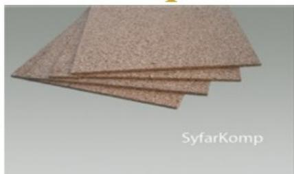
**SyfarTeKomp** lastre supercompatte che presentano densità maggiore ( $g = \div 300 \text{ kg/Mc}$ ) e spessori di molto inferiori (mm 5-10-15 e novità assoluta: misure frazionate) che possono sostituire i normali pannelli isolanti standard nelle situazioni in cui è necessario risparmiare spazio senza trascurare troppo la coibentazione.
